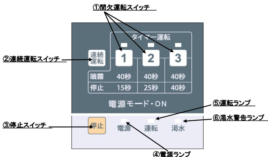
**間欠運転** : ①間欠運転スイッチを5秒間押し続けてください。間欠運転ができます。
